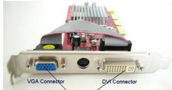
شکل ۳: نمایی از کارت گرافیک و محل اتصال کابل مانیتور
